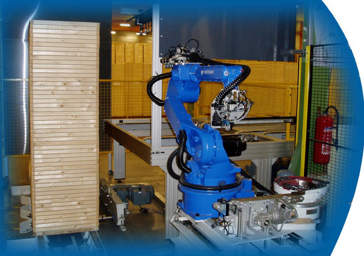
Cellule robotisée d'agrafage automatique de clés sur portes
